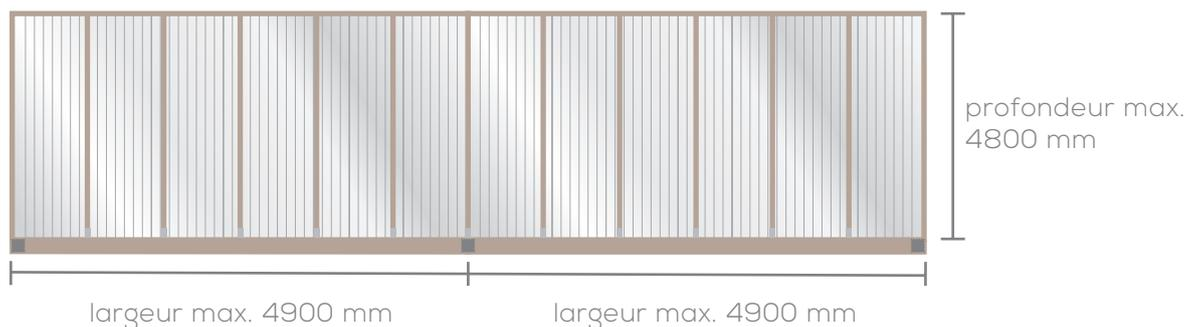
Le profondeur indique est le profondeur maximale jusqu'au côté intérieur du chéneau.
